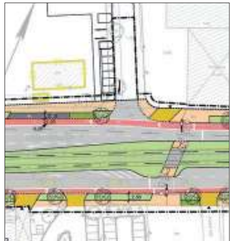
Bild 3: Fußgängerquerung in Höhe der Zufahrt nach Norden – bis hierher ist die Ostendstraße von Westen kommen mehrspurig.
