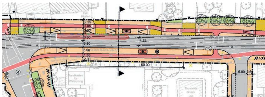
*Bild 4: Haltestelle an der Thusneldaschule – der nicht (mehr) betroffene Baumbestand auf dem Schulgelände ist weiß dargestellt, die nun barrierefreie Haltestelle kann von Osten wie von Westen sicher erreicht werden, Autoverkehr und Straßenbahn teilen sich in diesem Bereich die Spuren.*
